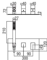
**Façade apparente monocommande à 2 sorties**
