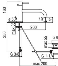
**Mitigeur monocommande avec bec long**
