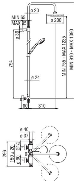
**Thermostatique extérieur avec corps froid et rampe télescopique**
