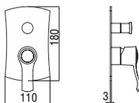
**Façade apparente monocommande à encastrer à 2 sorties**
