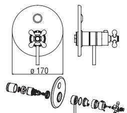
**Façade apparente thermostatique à encastrer 1 sortie**
