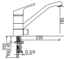
**Mitigeur monocommande avec raccord lave-vaisselle**
