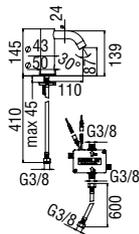
**Commande infrarouges monotrou**
