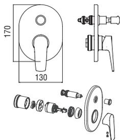
**Façade apparente monocommande à encastrer à 2 sorties**
