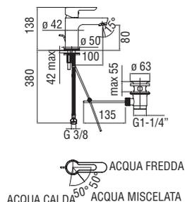
**Mitigeur monocommande à économies d'énergie avec débit 5 l/min**
