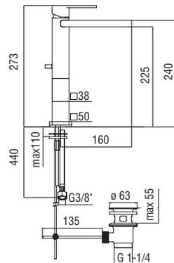
**Mitigeur monocommande rehaussée avec bec à cascade**
