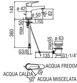
**Mitigeur monocommande à économies d'énergie avec débit 5 l/min**
