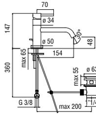
**Mitigeur monocommande avec bec long**
