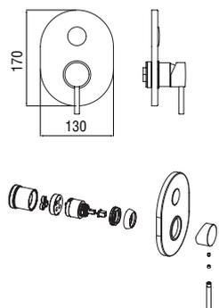
**Façade apparente monocommande à encastrer à 1 sortie**
