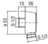
**Prise d'eau**· Sortie  $\varnothing$  1/2"
