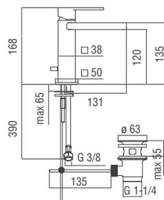
**Mitigeur monocommande avec bec à cascade**
