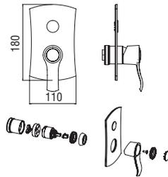
**Façade apparente monocommande à encastrer à 1 sortie**
