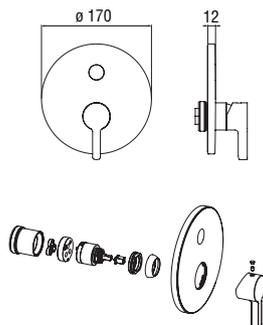
Façade apparente monocommande à encastrer à 1 sortie
