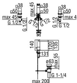
**Mélangeur 3 trous avec bec à cascade**
