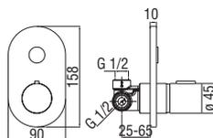
**Mitigeur monocommande à encastrer 1 sortie**
