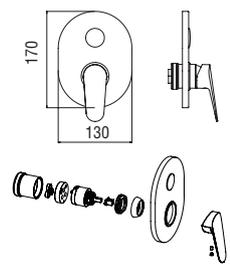
**Façade apparente monocommande à encastrer à 1 sortie**
