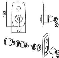
**Façade apparente monocommande à encastrer à 1 sortie**
