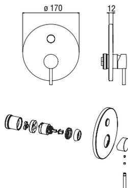
**Façade apparente monocommande à encastrer à 1 sortie**
