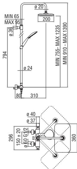
**Thermostatique extérieur avec corps froid et rampe télescopique**
