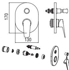
**Façade apparente monocommande à encastrer à 2 sorties**
