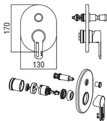
**Façade apparente monocommande à encastrer à 2 sorties**
