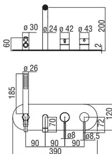
**Façade apparente monocommande à 2 sorties**
