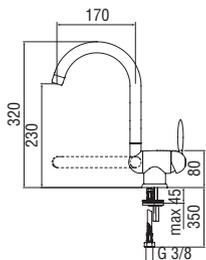
**Mitigeur monocommande avec bec rabattable**
