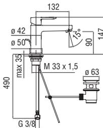
**Mitigeur monocommande avec bec long**
