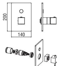
**Façade apparente thermostatique à encastrer 1 sortie**
