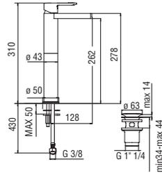
**Mitigeur monocommande rehaussée avec bec à cascade**
