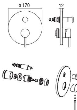
**Façade apparente monocommande à encastrer à 2 sorties**
