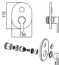
**Façade apparente monocommande à encastrer à 1 sortie**
