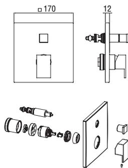
**Façade apparente monocommande à encastrer à 2 sorties**
