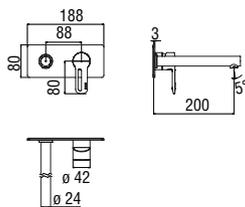
**Façade apparente monocommande murale avec bec long**
