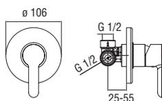
**Mitigeur monocommande à encastrer 1 sortie**
