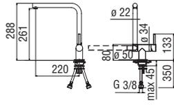
**Mitigeur monocommande avec bec rabattable**
