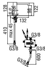
**Commande infrarouges monotrou**
