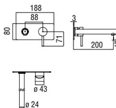
**Façade apparente monocommande murale avec bec long**
