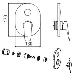
**Façade apparente monocommande à encastrer à 1 sortie**
