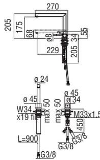
**Mitigeur monocommande avec bec escamotable**
