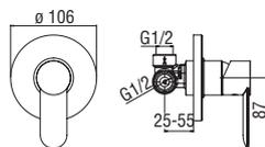
**Mitigeur monocommande à encastrer 1 sortie**
