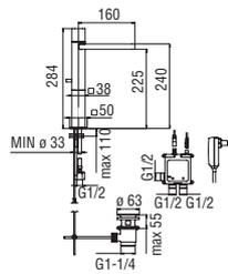
**Commande électronique rehaussée avec bec à cascade**
