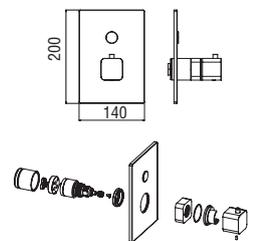
**Façade apparente thermostatique à encastrer 1 sortie**
