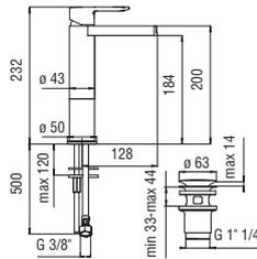
**Mitigeur monocommande rehaussée avec bec à cascade**
