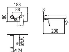
**Façade apparente monocommande murale avec bec long**
