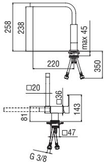
**Mitigeur monocommande avec bec rabattable**
