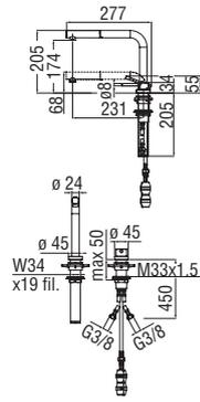
**Mitigeur monocommande avec bec escamotable**
