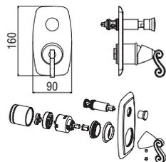
Façade apparente monocommande à encastrer à 2 sorties
