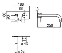
**Façade apparente monocommande murale avec bec long**
