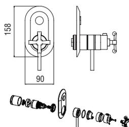
**Façade apparente thermostatique à encastrer 1 sortie**
