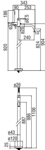
**Partie apparente monocommande à 2 voies**
