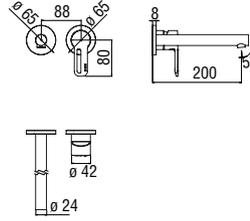
**Façade apparente monocommande murale avec bec long**
