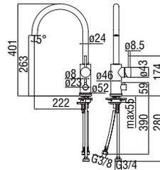
**Mitigeur monocommande avec raccord lave-vaisselle**
