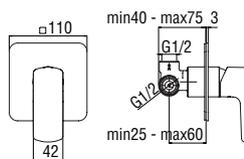
**Mitigeur monocommande à encastrer 1 sortie**
