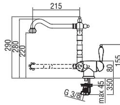
**Mitigeur monocommande avec bec rabattable**
