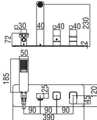
**Façade apparente monocommande à encastrer à 2 sorties**
