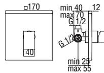
**Mitigeur monocommande à encastrer 1 sortie**
