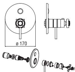
**Façade apparente thermostatique à encastrer 1 sortie**
