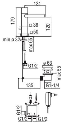
**Commande électronique avec bec à cascade**
