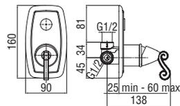
**Mitigeur monocommande à encastrer 1 sortie**
