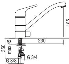
**Mitigeur monocommande avec raccord lave-vaisselle**
