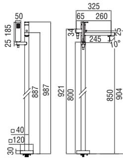
**Partie apparente monocommande à 2 voies**
