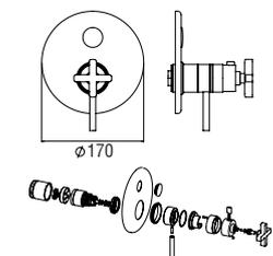
Façade apparente thermostatique à encastrer 1 sortie
