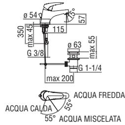
**Mitigeur monocommande à économies d'énergie avec débit 5 l/min**
