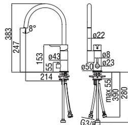
**Mitigeur monocommande avec raccord lave-vaisselle**
