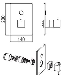
**Façade apparente thermostatique à encastrer 1 sortie**
