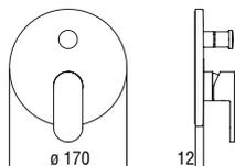
**Façade apparente monocommande à encastrer à 2 sorties**
