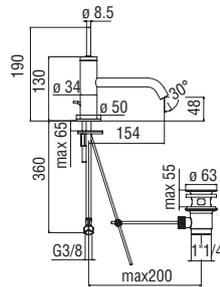
**Mitigeur monocommande avec bec long**
