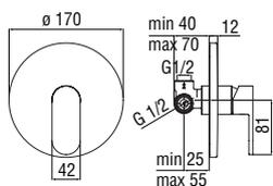
**Mitigeur monocommande à encastrer 1 sortie**
