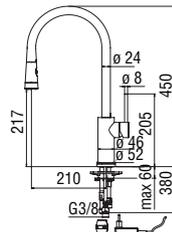
**Mitigeur monocommande avec éclairage**
