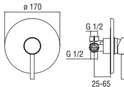
**Mitigeur monocommande à encastrer 1 sortie**
