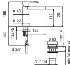
**Mitigeur monocommande avec bec à cascade**
