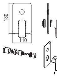
**Façade apparente monocommande à encastrer à 1 sortie**
