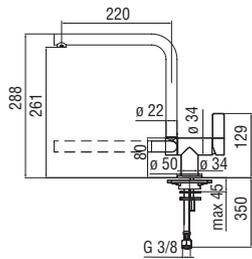
**Mitigeur monocommande avec bec rabattable**
