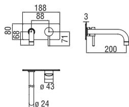
**Façade apparente monocommande murale avec bec long**
