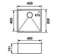
**EVSP52** Cuve sous-plan. Bonde de ø 90 mm / Cotes hors tout (mm) : 390 L x 450 l x 191 P - Cuve : 340 L x 400 l.
