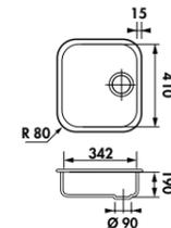
**EVSP12** Cuve de forme rectangulaire. Bonde de  $\varnothing$  90 mm / Cotes hors tout (mm) : 372 L x 312 x l 170 P - Cuve : 290 L x 350 l.
