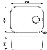
**EVSP11** Cuve de forme rectangulaire. Bonde de  $\varnothing$  90 mm / Cotes hors tout (mm) : 440 L x 372 l x 190 P - Cuve : 342 L x 410 l.
