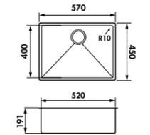
**EVSP53** Cuve sous-plan. Bonde de ø 90 mm / Cotes hors tout (mm) : 450 L x 450 l x 191 P - Cuve : 400 L x 400 l.
